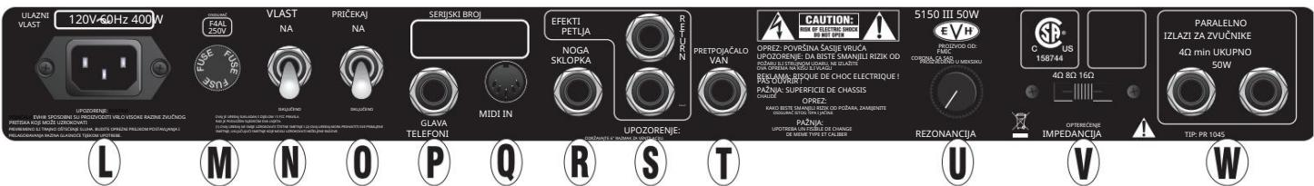
L. ULAZ NAPAJANJA: Ovdje spojite priloženi kabel za napajanje na pojačalo, u skladu s naponom i frekvencijom navedenim na stražnjoj ploči pojačala.
